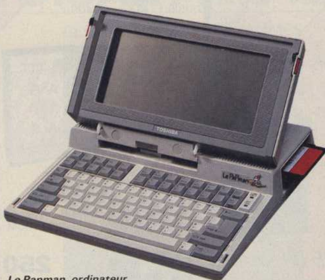
Le Papman, ordinateur complet, avec son écran et un lecteur de microdisquettes.
